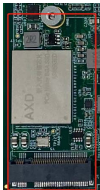
图3.3 M.2 E-Key Type 2242 接口插座
